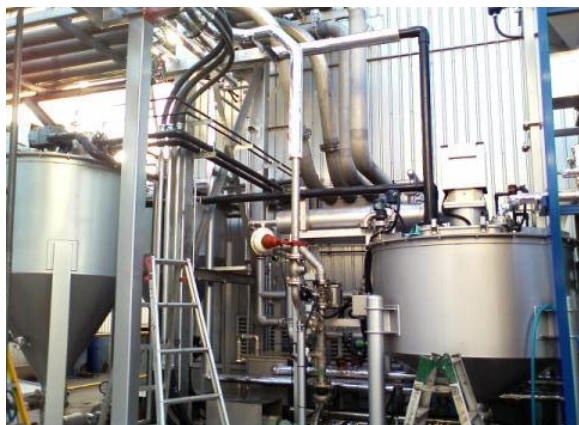
原料タンク(左)と酵素反応装置
